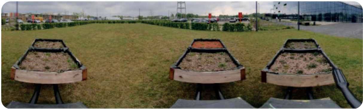
Essai de toitures vertes avec substrat contenant des granulats recyclés © Projet TETRA Green Roofs Up ! Hogeschool PXL, 2022
