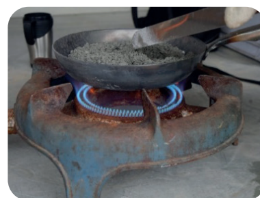
Exemples de méthodes de détermination de la teneur en eau. De gauche à droite, étuve, four à micro-ondes et poêle sur flamme (Sources : CRR, FEREDCO et JB Conseils).
