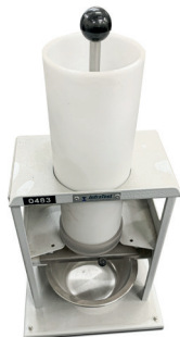
Appareil de mesure du coefficient d'écoulement des sables (FEREDECO)
