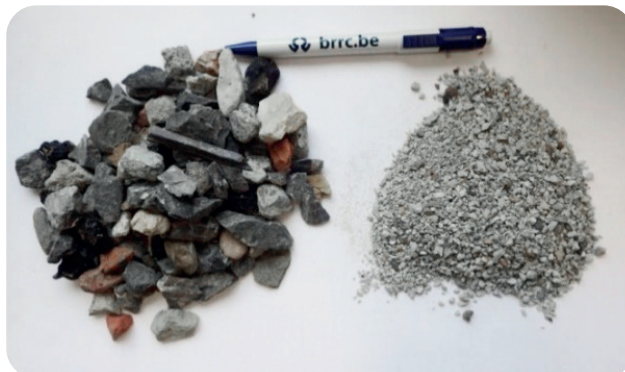
Exemples de roche crayeuse en cours de processus de gélifraction (à gauche) ou de recyclés après l'essai de sensibilité au gel (à droite) (Source : Internet et JB Conseils).
