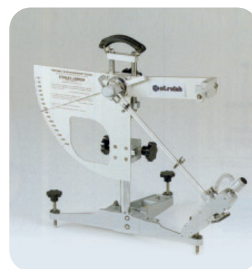
Exemples d'appareils et de plaquette utilisés pour un essai CPA (JB Conseils)
