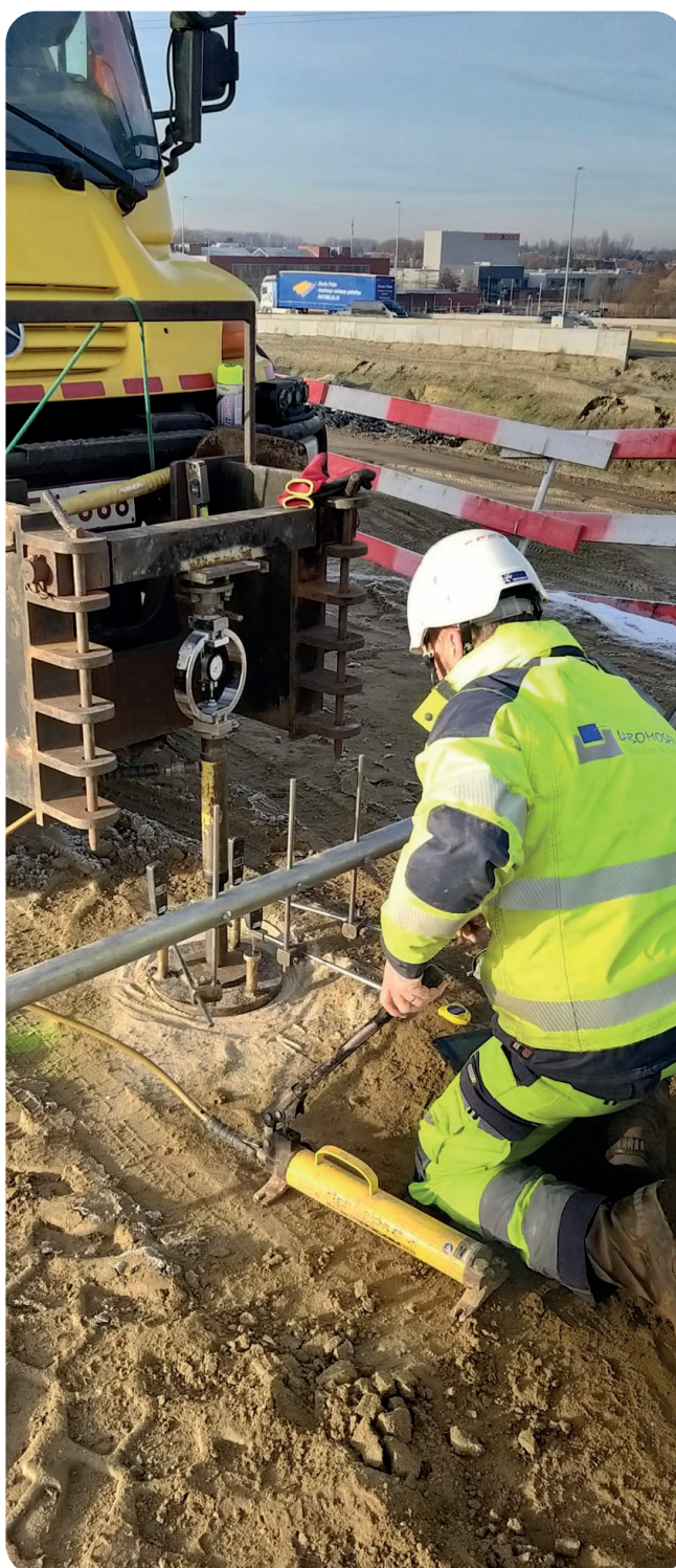
Essai statique à la plaque
