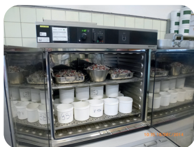
Exemples de méthodes de détermination de la teneur en eau. De gauche à droite, étuve, four à micro-ondes et poêle sur flamme (Sources : CRR, FEREDCO et JB Conseils).
