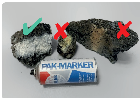
Test de détection de goudron dans les déchets d'hydrocarbonés
