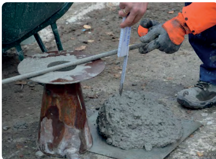
Mesure de la consistance du béton à base de granulats recyclés (monographie Buildwise-CRR)
