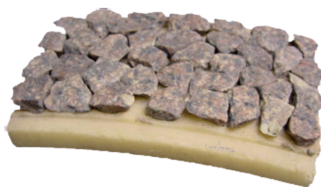
Exemples d'appareils et de plaquette utilisés pour un essai CPA (JB Conseils)
